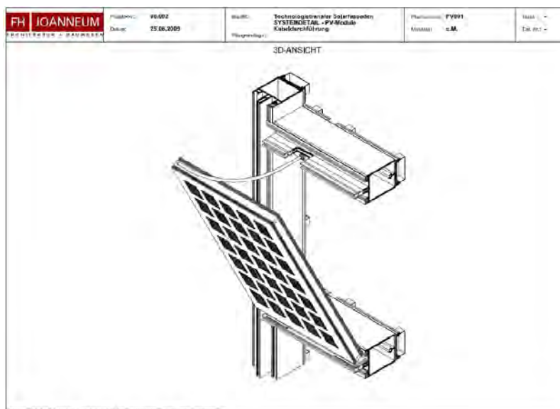
Abbildung 21: Einbau eines Photovoltaik-Elementes: Systemdetail Kabeldurchführung (PFEILER 2009)
