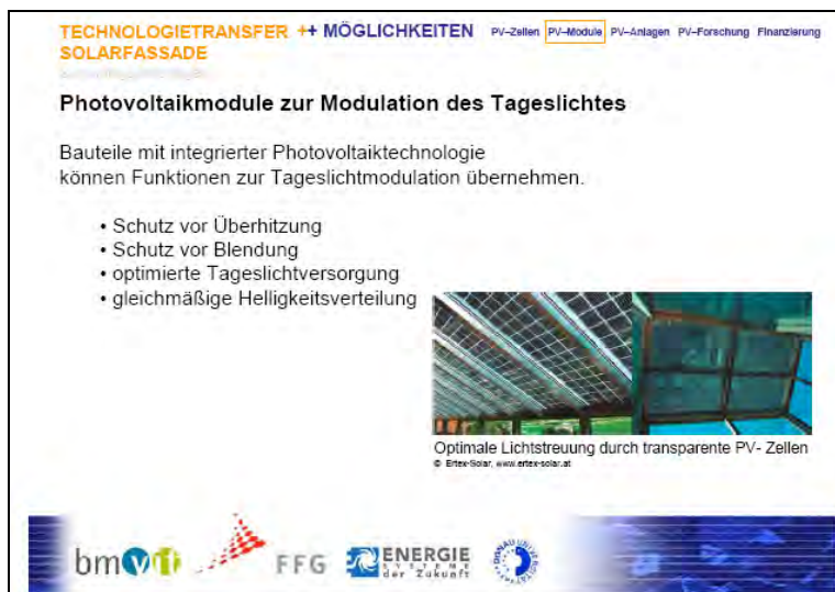
Abbildung 83: GIPV-Schulungsfolie: PV zur Tageslichtmodulation
