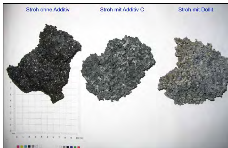
Abbildung 11: Schlackebrocken aus der Verbrennung der drei Versuchsbrennstoffe
