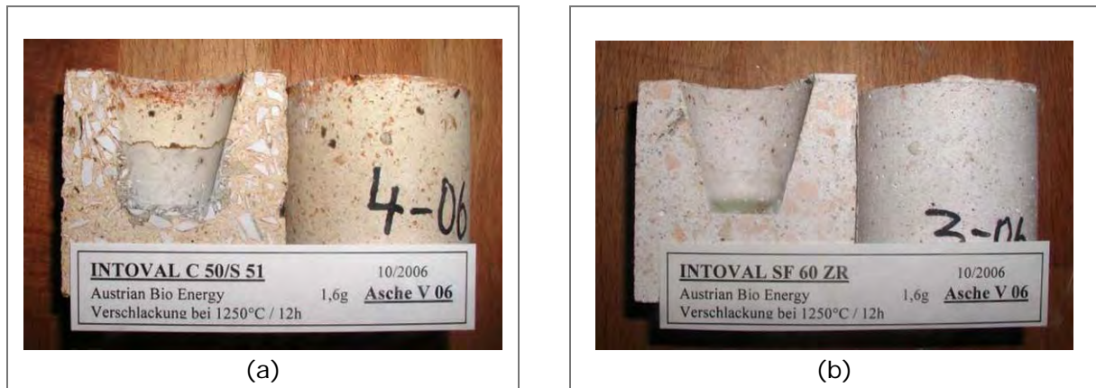
Abbildung 2: Exemplarisch 2 Proben aus dem Tiegeltest im Vergleich (a) deutliche Veränderungen des Feuerfestmaterials in der Randzone (b) keine Veränderung des Materials erkennbar
