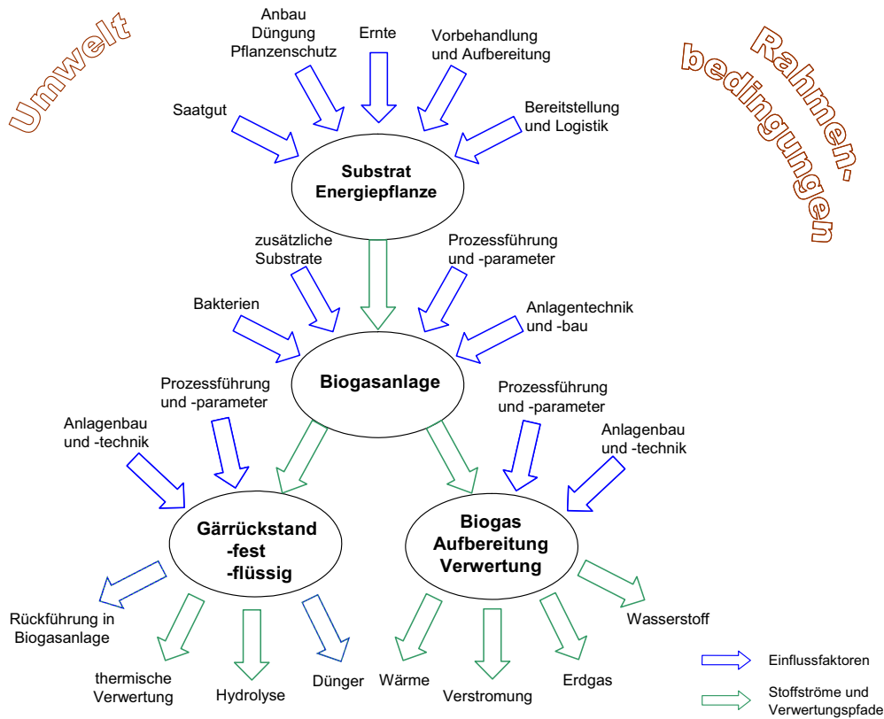
Abbildung 4: „Teilbereiche, Einflussfaktoren, Stoffströme und Verwertungspfade im System Biogas aus Energiepflanzen“
