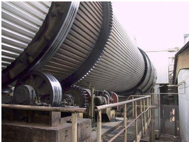
**Abbildung 66: Trommeltrockner Holzverarbeitung (Trockner: Quelle Wikipedia)**
