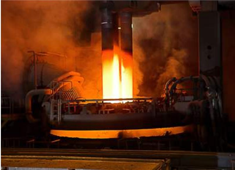
**Abbildung 61: Lichtbogenofen (Quelle: Siemens)**
