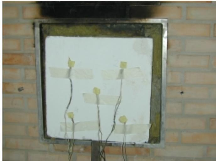
Abbildung 27: Brandversuch mit Kleinprobe – Außenwand mit Temperaturmessfühlern
