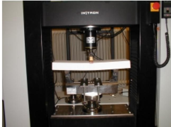
**Abb. 3-8:** Versuchsaufbau für den Biegeversuch
