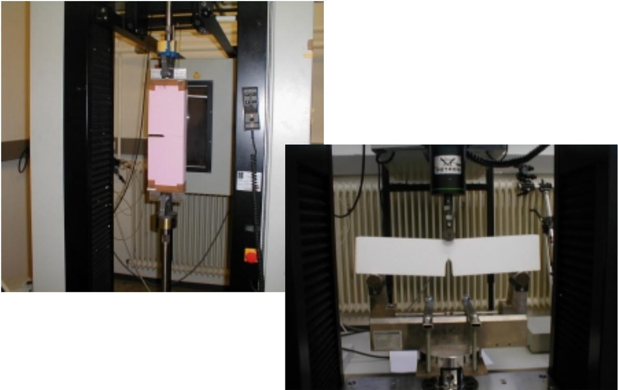
**Abb. 3-16:** Versuchsaufbau für Risszähigkeitsuntersuchung.
